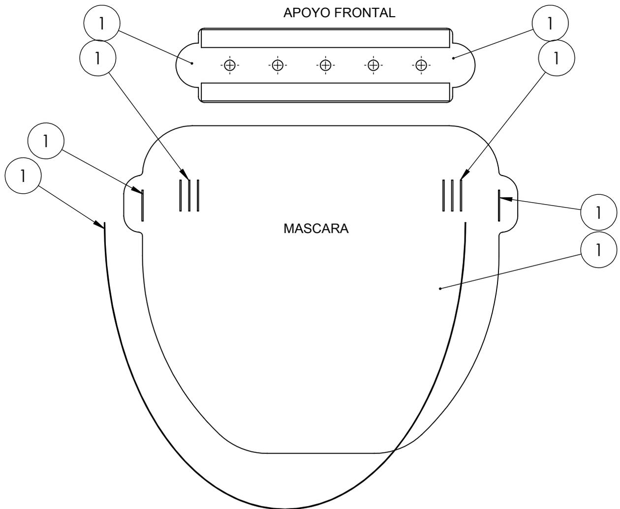
INSERTAR EL ELASTICO EN LA RANURA QUE LE CORRESPONDE (SEGUN DIBUJO)
